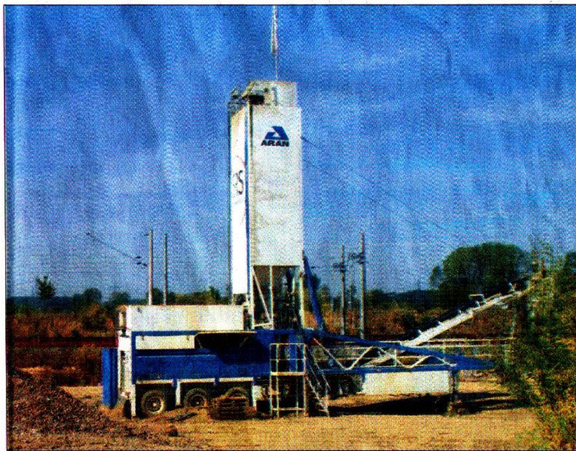
In solchen ARAN-Anlagen wird das Bodenmaterial der alten Bahntrasse in Sinzheim und Steinbach aufgearbeitet, so dass es wieder verwendet werden kann.
